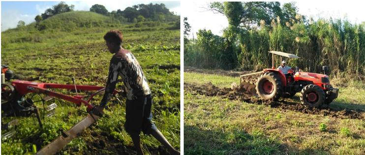
Pengolahan tanah menggunakan traktor mobil dan traktor tangan
